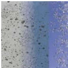
بتن دارای منافذ باز بدون حضور AQUAFIN-IC
